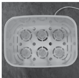
FIGURA D. Colocación de tubos de ventilacion de boca ancha
